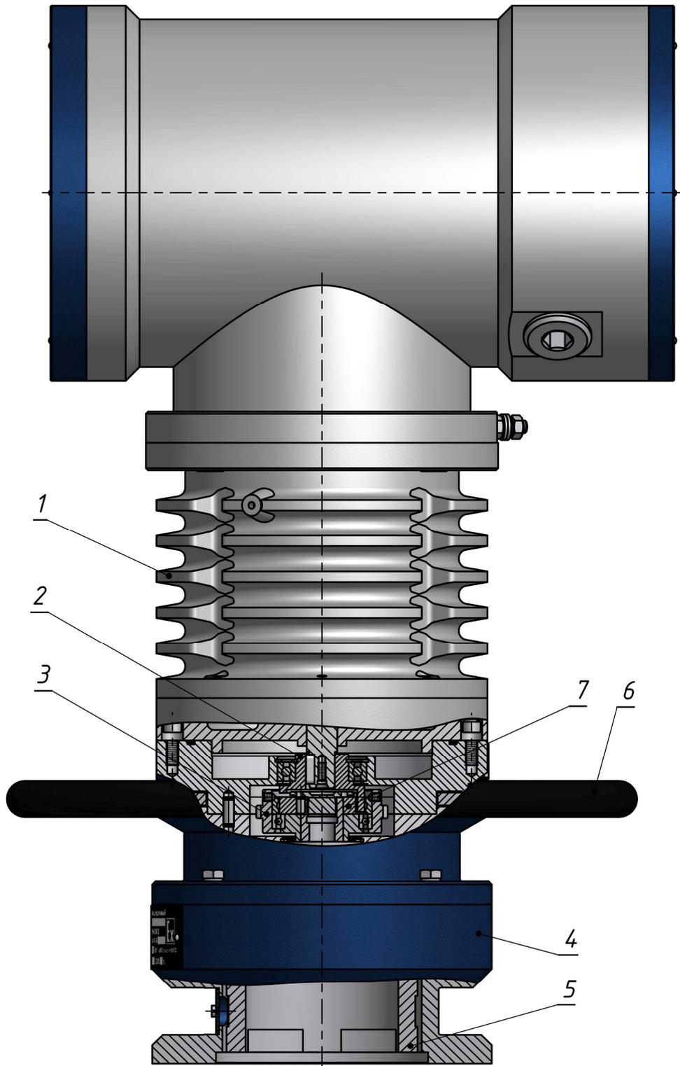
1. Электродвигатель; 2. Водило; 3. Муфта обгонная; 4. Волновой редуктор с промежуточными телами качения; 5. Выходное звено электропривода; 6. Маховик привода ручного дублера; 7. Звездочка обгонной муфты;
