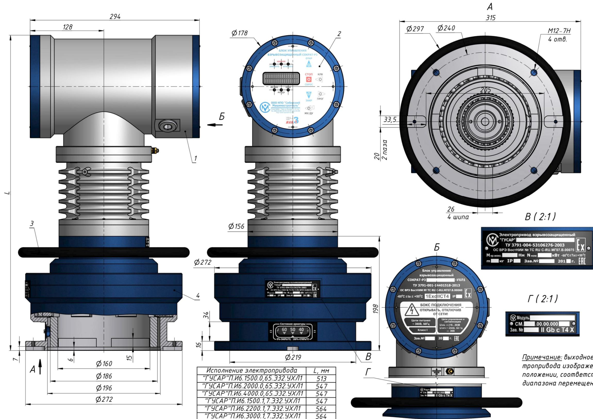
1. Блок управления СОКРАТ; 2. Встроенный пост управления (команды подаются магнитным ключом); 3. Привод механизма ручного дублера; 4. Волновой редуктор с промежуточными телами качения;
