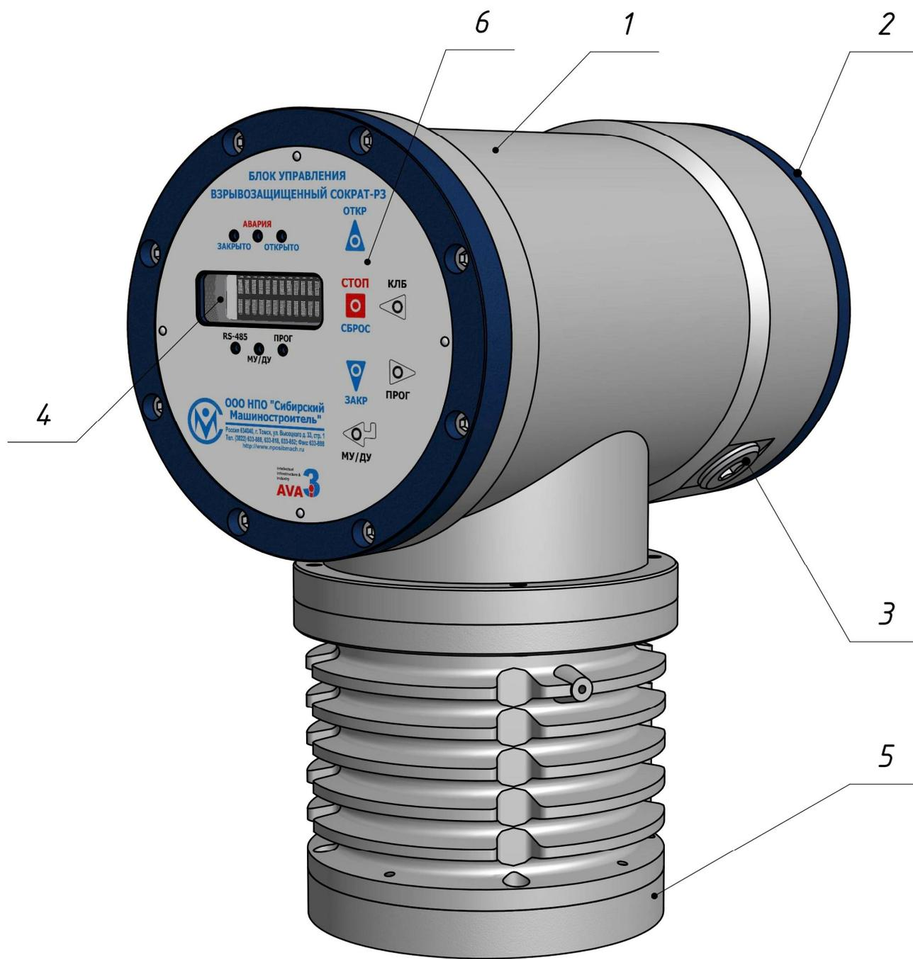
1. Корпус; 2. Крышка блока подключения питания и телеметрии; 3. Отверстия M25x1,5 для установки кабельных вводов (в состоянии поставки заглушены резьбовыми заглушками); 4. Смотровое окно индикатора; 5. Электродвигатель; 6. Встроенный пост управления (команды подаются магнитным ключом);
