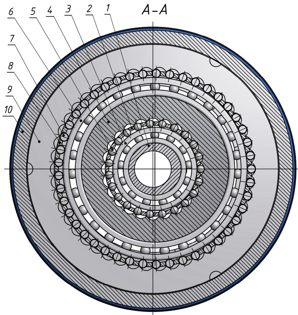
1. Входное звено (генератор) первой ступени; 2. Сепаратор первой ступени; 3. Подшипник; 4. Венец-генератор; 5. Промежуточное тело качения первой ступени (шарик); 6. Подшипник; 7. Промежуточное тело качения второй ступени (ролик); 8. Выходное звено (сепаратор) второй ступени; 9. Зубчатый венец с профильными впадинами сложной формы; 10. Корпус электропривода;
